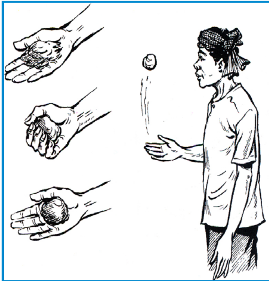
រូបភាពទី១១ របៀបពិសោធរើលគុណភាពដី Copyright © CEDAC 2010
