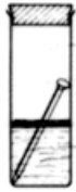
ទឹកពុះ (ដើម្បីដកអុកស៊ីសែន) ស្រោបដោយស្រទាប់ប្រេងឆារ
